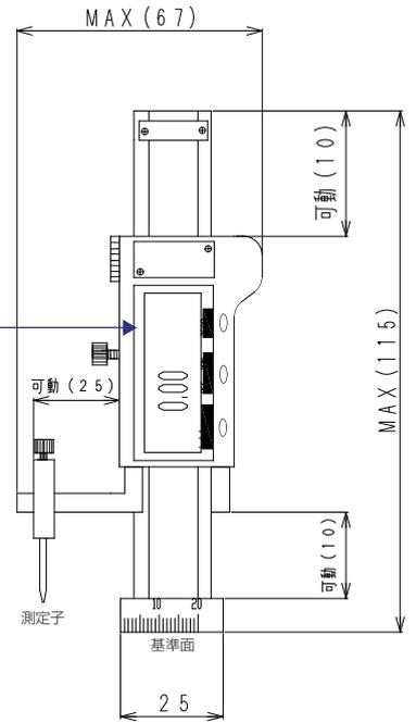
□デジタルの場合 測定範囲:±10mm / 目量:0.01mm / 器差:±0.03mm
