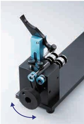
全ての測定器には手動タイミングベルト/プーリーによる駆動システムが標準装備となっており、測定するワークを連続的にスムーズに回転させる事が出来ます。
