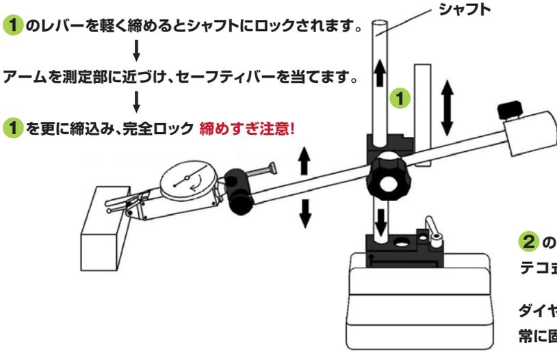
若干締め付ける事によりアームの動きを制限できるので、セーフティバーを使用しなくてもアプローチできます。
