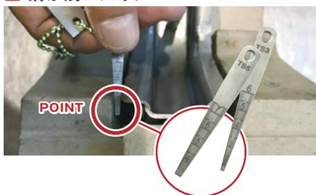
測定サイズ用に先端部分がカットされています。溝が浅い、傾斜がついているなど、先がぶつかってうまく測れないスキにお使いください。
